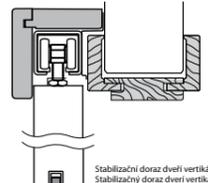
Stabilizační doraz dveří vertikální
